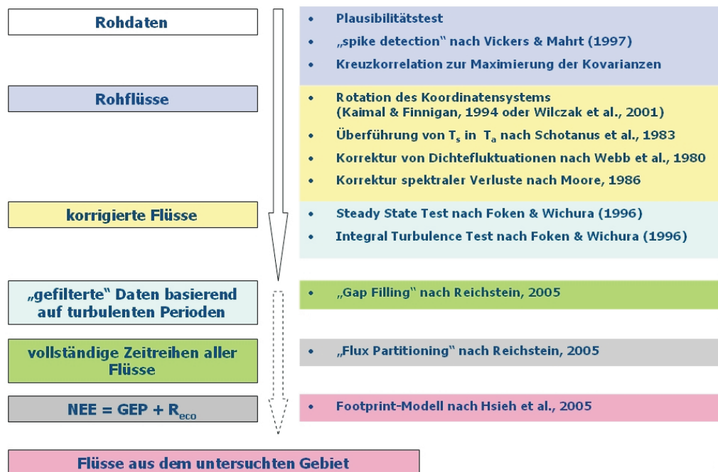
Abb. 12: Schema der Datenprozessierung und der einzelnen Korrekturverfahren für die Ermittlung der Kohlenstoff- und Wasserflüsse
